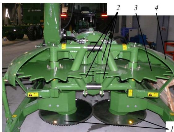
Fot. 5. Zespół wciągający ścięte pędy: 1 - piły tarczowe, 2 - walce wciągające, 3 - tarcze nagarniające, 4 - osłona bezpieczeństwa
