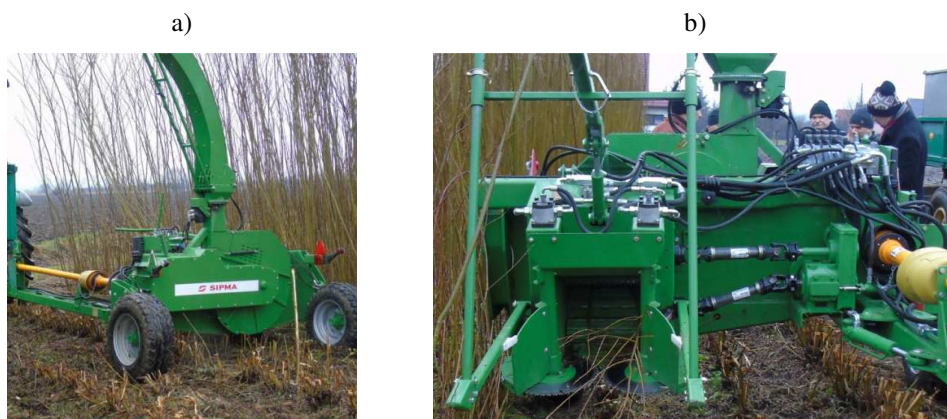
Fot. 1. Prototyp sieczkarni jednorzędowej SIPMA SR 1010 HERO podczas pracy w widoku z tyłu (a) oraz z przodu (b)
