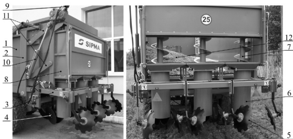
Fot. 1. Urządzenie do podpowierzchniowego dawkowania osadów ściekowych do gruntu: 1 – rozrzutnik nawozów, 2 – rama nośna, 3 – belka, 4 – krój tarczowy, 5 – obsypnik talerzowy, 6 – cylindryczna obudowa ślimaka, 7 – podajnik ślimakowy, 8 – komora zasypowa, 9 – silnik hydrauliczny, 10 – siłownik hydrauliczny, 11 – ramiona, 12 – nawóz
