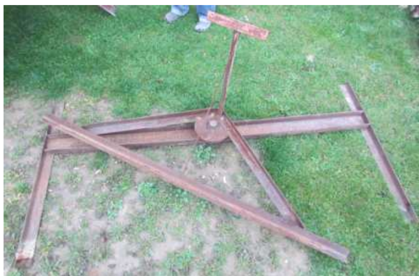
Fot. 3. Metalowy stojak na kolektor słoneczny Źródło: fot. M. Dyląg
