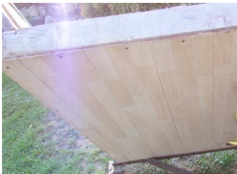
Fot. 5. Zabezpieczenia tylnej części kolektora słonecznego
